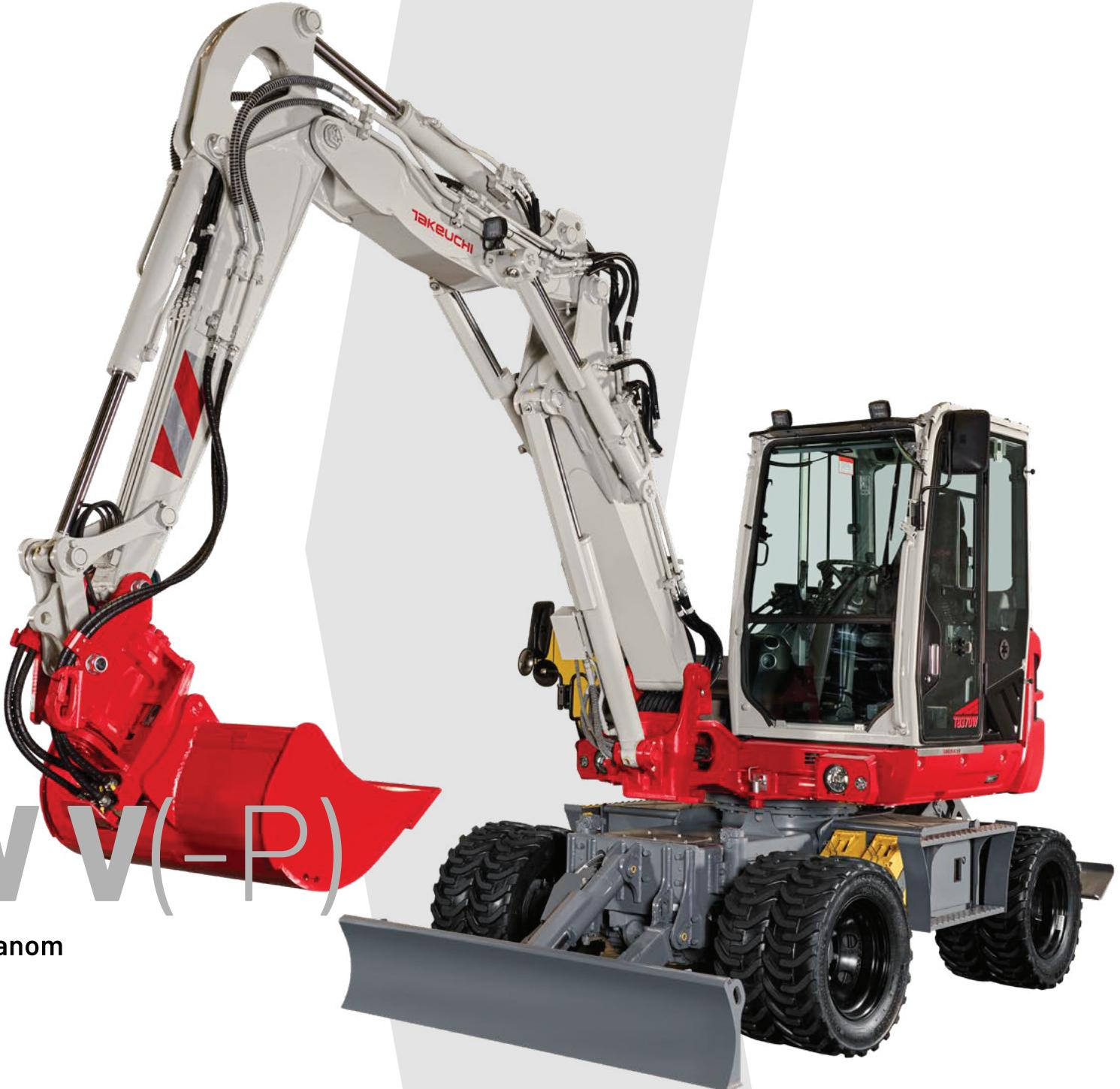
**TB370W V je novi bager na kotačima marke Takeuchi u klasi od 8 tona.** Četiri hidraulička upravljačka kruga mogu se potpuno zasebno kontrolirati putem novih multifunkcionalnih joysticka. Time tvoj mobilni bager postaje multifunkcionalni alat na gradilištu. Dvodijelna grana i snažni motor proširuju radni i operativni raspon okretnog TB370W V.
