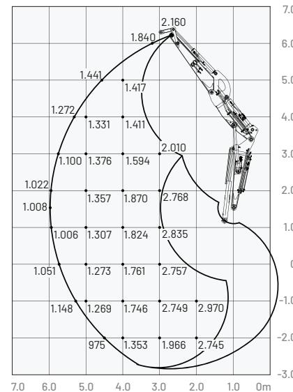
Dvodijelna grana, bez stabilizatora
