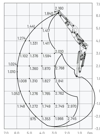
Opterećenje u dijagramima (lijevo) su unutar 87 % hidrauličkog kapaciteta dizanja i unutar 75 % kapaciteta prvrtnjanja.
