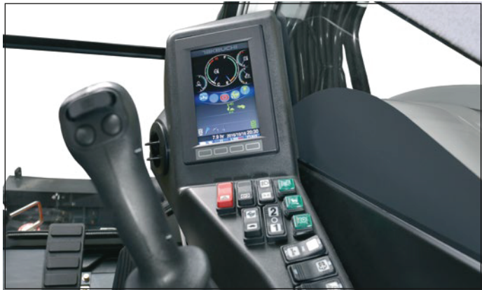
Display mit Haupt- und Nebensichtfeldern, Überwachung des Betriebszustands, mit Norm- und Spezialbetriebsmoden, mit Eco-Modus.
