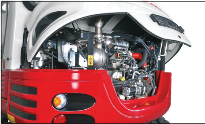
Verbrauchs-, abgas- und lärmreduzierender Turbo Dieselmotor. Common-Rail von DEUTZ mit Abgasstufe 5.
