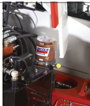
Mengengesteuerte Zentralschmieranlage mit Leerstandsmeldung
