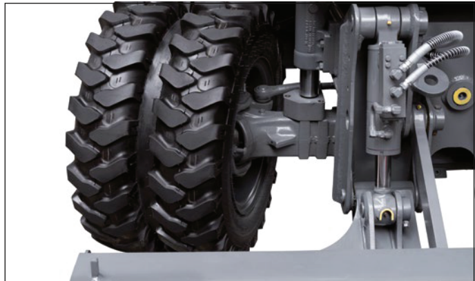
Qualität: Achsen von Dana Spicer. Lenkachse als Pendelachse ausgeführt, mit automatischer Pendelachssperre. 8-fache Bereifung. Straßenzulassung.
