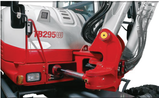
Robuster Schwenkbock mit besonders geschützter Schlauchführung und hydraulischer Seitenversetzung.
