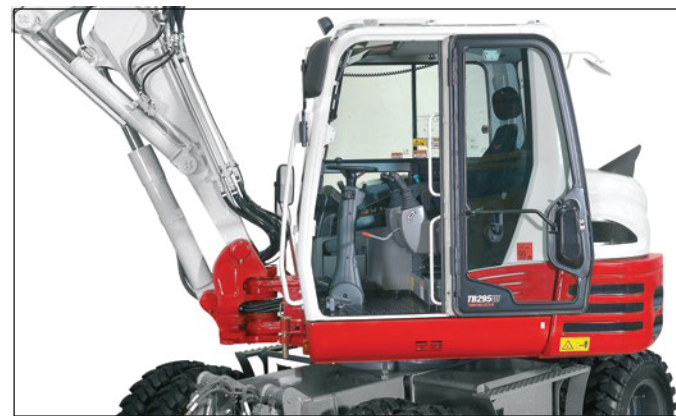
Schallgedämpfte, vibrationsarme Komfortkabine mit Ablagefächern. Innovative Lenksäulenverstellung für ein komfortables ein- und aussteigen.
