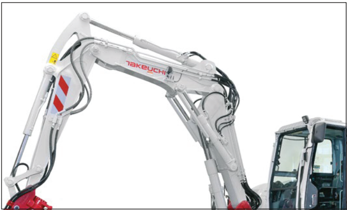
Verstellausleger mit 4 Steuerkreisen, davon 3 proportional gesteuert, regulierbare Literleistung.
