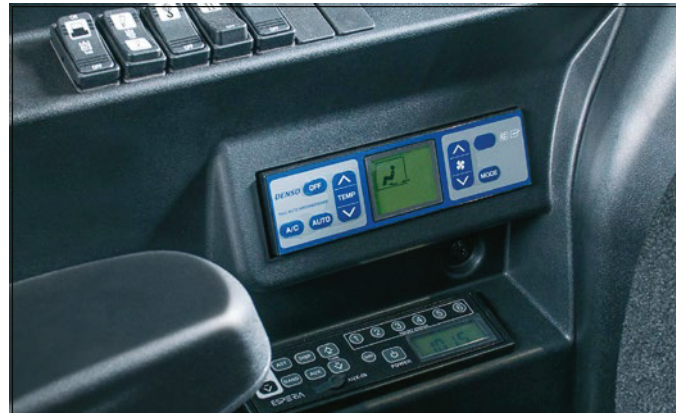
Climatronic: Temperaturgesteuerte Klimaanlage mit Entfroster-, Economy- und Umluftmodus für Schutz und Komfort.
