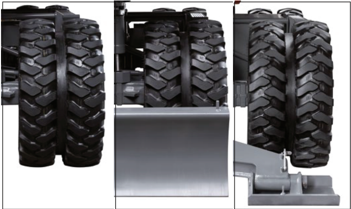
Abstützpratten (optional) für ideale Standfestigkeit, abnehmbar und durch zusätzliches Planierschild ersetzbar.
