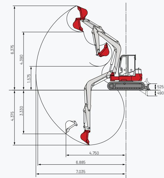
Opterećenja u dijagramima su unutar 87 % hidrauličkog kapaciteta dizanja i unutar 75 % kapaciteta prevrtanja.
