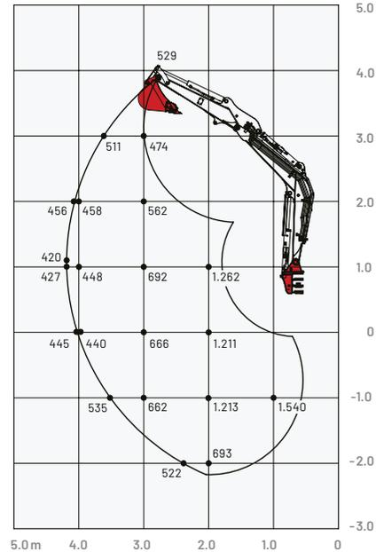
Opterećenja u dijagramu su unutar 87 % hidrauličkog kapaciteta dizanja i unutar 75 % kapaciteta prevrtanja.
