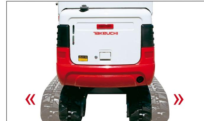
Raupenwerk mit hydraulischer Spurverbreiterung.
