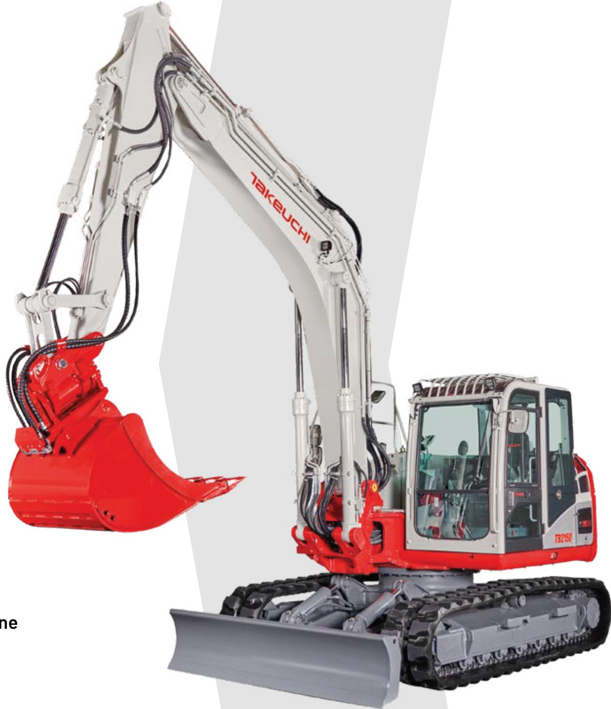
**Bagerom TB2150 s okretnom kabinom i bočnim pomakom lako je kopati paralelno sa zidom.** TB2150 je bager od 16 tona i najveći u obitelji TAKEUCHI, ali radi kao mini bager.
