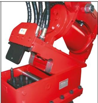
System Huppi-Quick: Hydraulikanschlüsse werden beim Schnellwechsellvorgang automatisch verbunden
