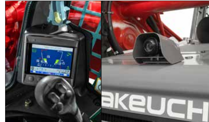
Übersichtliches Multifunktionsdisplay mit Einblendung der Rückfahrkamera.
