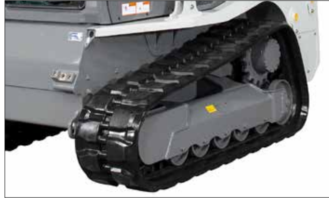
Zwei Planetenantriebe sorgen für eine optimale Fahrgeschwindigkeit und liefern genügend Kraft für das Arbeiten mit schweren Anbaugeräten.
