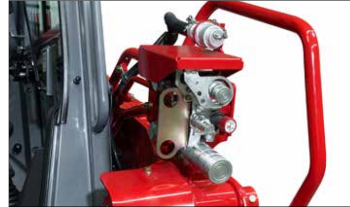
Durch den Zusatzsteuerkreis und den 14-poligen Zusatzstecker kann die Maschine für eine Vielzahl von Anbaugeräten verwendet werden.
