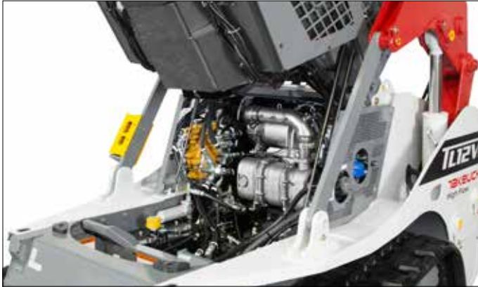
Die kippbare Kabine ermöglicht einen einfachen Zugang zum Motor und den Haupt-Hydraulikkomponenten.
