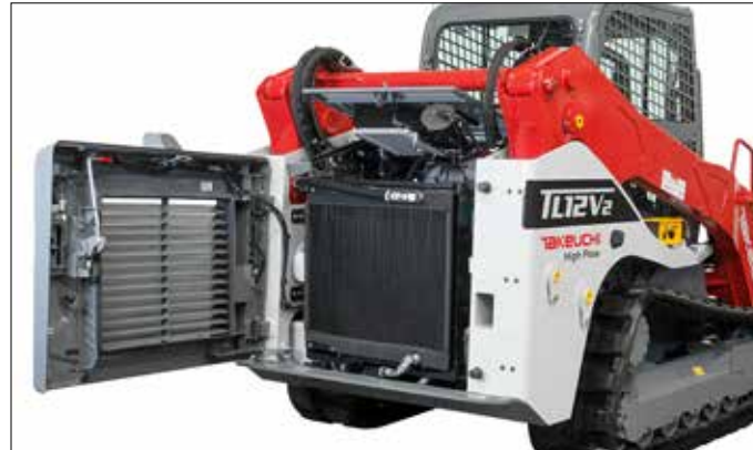
Der aufklappbare Heckbereich garantiert optimale Zugänglichkeit zur Kühlerreinigung und bei Wartungsarbeiten am Dieselmotor.
