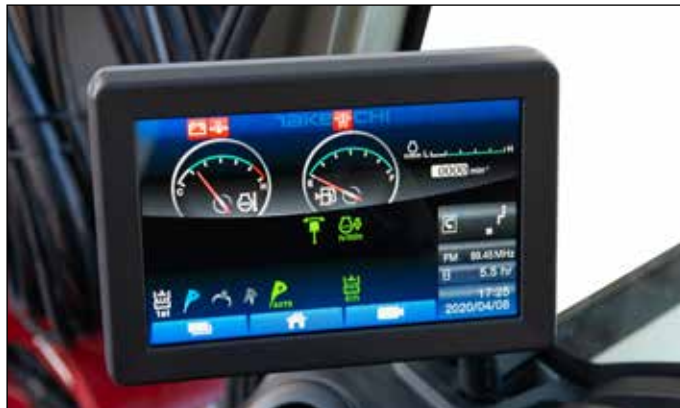
Neues 8" Multifunktions-Farb-Touch-Display: Werkstattemenü mit neuen Funktionen, automatische Einblendung der Rückfahrkamera, kratzfest, anlauffest.
