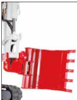
HUPPTilt mit HUPPPlate H, Tieföffel als Hochöffel montiert
