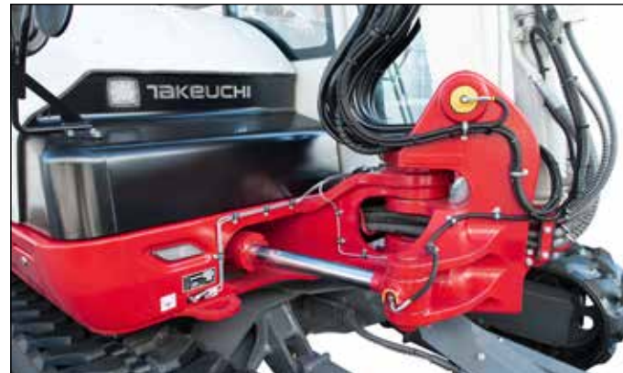
Robuster Schwenkbock. Schwen-, Hub- und Stielzylinder mit Endlagendämpfung. Überlastwarneinrichtung und Schlauchbruchsicherung.
