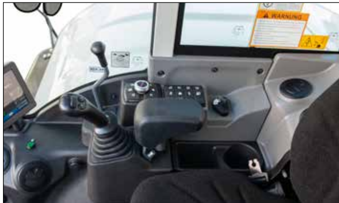
Proportionale Ansteuerung der Zusatzhydraulik über den rechten und linken Joystick. Neuer innovativer 3D-Bedienknopf für mehr Komfort.
