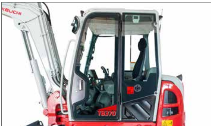
Vibrationsarme, schallgedämpfte Kabine mit breitem Einstieg und Komfortlicht, hochklappbare Frontscheibe, Klimaanlage serienmäßig.
