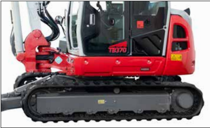
Laufrollen mit Innen- und Außenführung für sicheren Gummikettenlauf und Double-Short-Pitch Gummiketten für vibrationsarmes Fahren.
