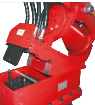
HUPPQuick-System: Hydraulikanschlüsse werden beim Schnellwechselvorgang automatisch verbunden
