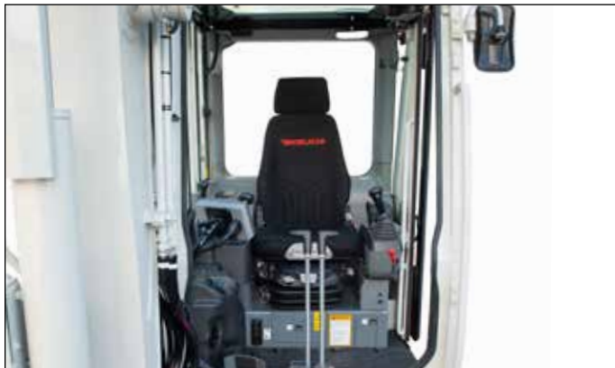
Ergonomischer, luftgefederter Komfortsitz mit Sitzheizung und optimal angeordneten Bedienelementen für ermüdungsfreies Arbeiten.
