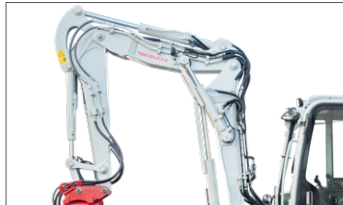
TB370 mit Verstellausleger erhältlich. 4 Steuerkreise, davon 3 proportional gesteuert, regulierbare Literleistung.
