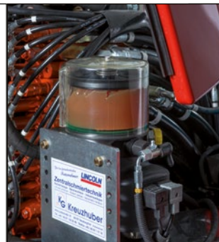
Mengengesteuerte Zentralschmieranlage mit Leerstandsmeldung
