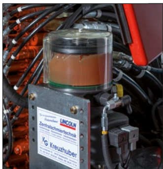
Mengengesteuerte Zentralschmieranlage mit Leerstandsmeldung
