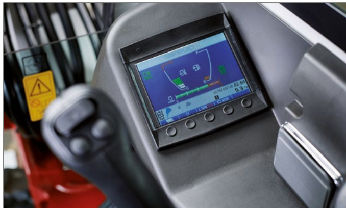
Übersichtliches Display mit optischen und akustischen Überwachungseinheiten. ECO-Betrieb zur Erhöhung der Wirtschaftlichkeit und Verringerung des Dieselverbrauchs.
