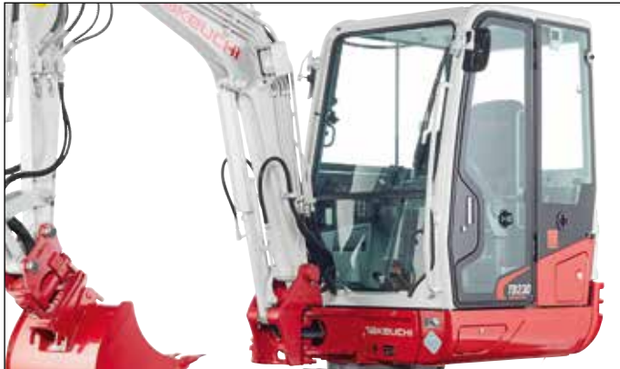
Große, schallgedämpfte, vibrationsarme Kabine mit Ablagefächern, breiter Einstieg mit massiver Türarretierung und hochklappbarer Frontscheibe.
