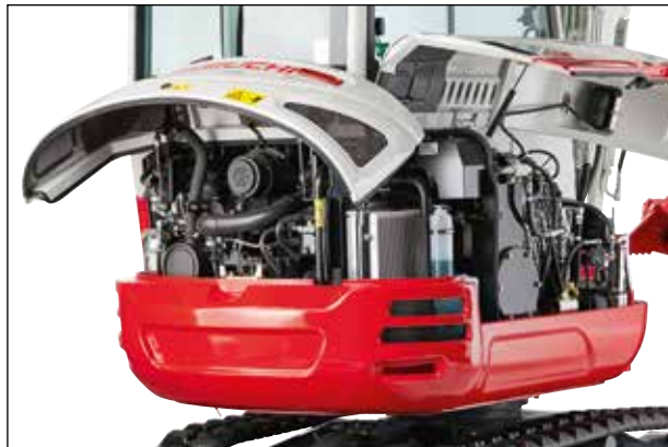
Großzügige Wartungsklappen für servicefreundlichen Zugang zu Motor und Hydraulikaggregaten.
