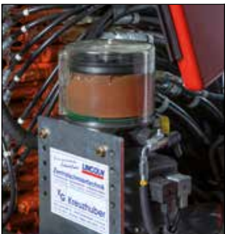
Mengengesteuerte Zentralschmieranlage mit Leerstandsmeldung
