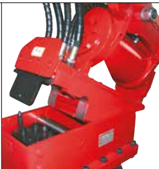
System Huppi-Quick: Hydraulikan-schlüsse werden beim Schnellwech-selvorgang automatisch verbunden
