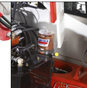
Mengengesteuerte Zentralschmieranlage mit Leerstandsmeldung
