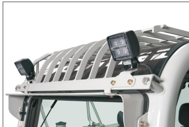
LED-Scheinwerfer für bestmögliche Sicht beim Arbeiten in der Dämmerung oder im Untertagebau.
