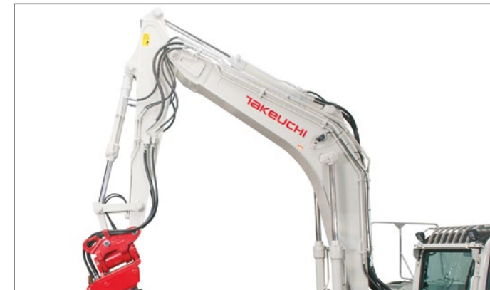
4 Steuerkreise, davon 3 proportional gesteuert, regulierbarer Druck und Literleistung.
