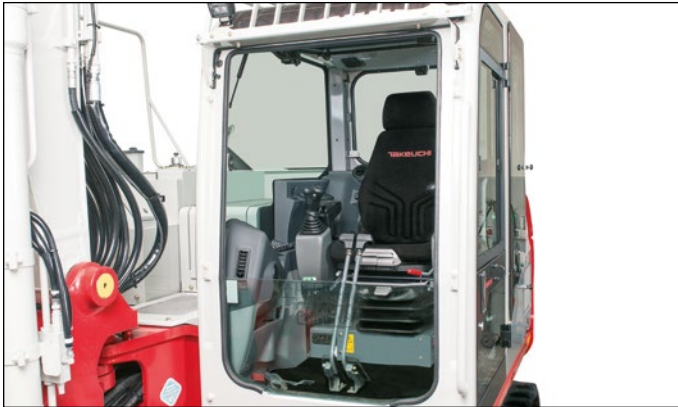
Schallgedämpfte, vibrationsarme Komfortkabine mit Ablagefächern.
