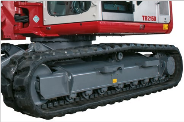
Doppelte Laufrollenführung und extrastarkes Leitrad.
