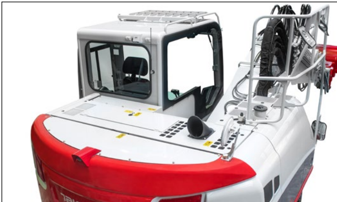
Die durchgehende Seitenscheibe ermöglicht eine uneingeschränkte Rundumsicht.
