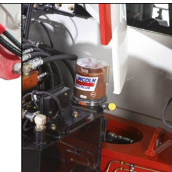
Mengengesteuerte Zentralschmieranlage mit Leerstandsmeldung
