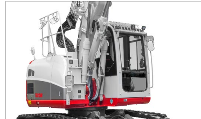
Innovative, außenliegende Schlauchführung bietet besonderen Schutz vor Beschädigungen.
