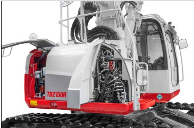
Wartungsfreundlicher Zugang zu den Aggregaten.
