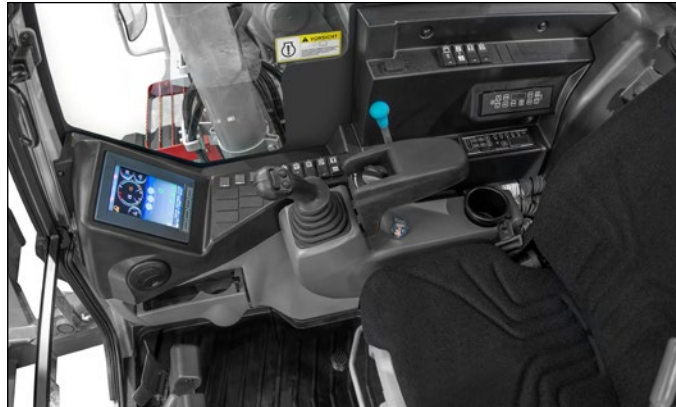
Großes, übersichtliches und bedienerfreundliches Display mit Einblendung der Rückfahr- und Seitenkamera.
