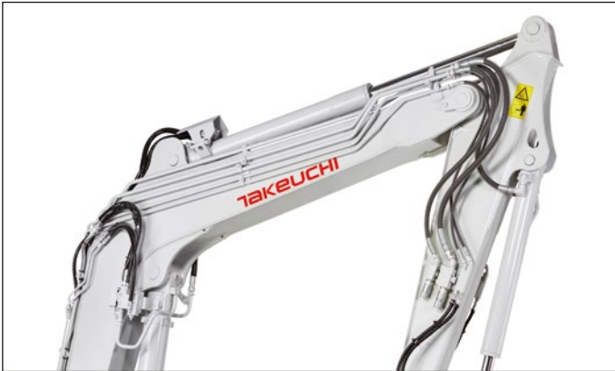
4 Hydrauliksteuerkreise serienmäßig bei TB280FR. 3 Hydrauliksteuerkreise bei TB138FR und TB153FR für eine Vielzahl von Anbaugeräten.
