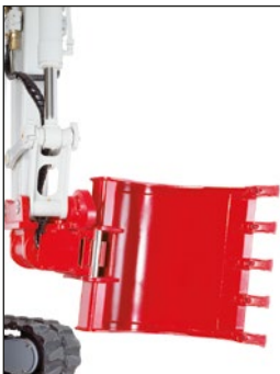
Powertilt mit hydr. Schnellwechsellplatte, Tieflöfel als Hochlöfel montiert
