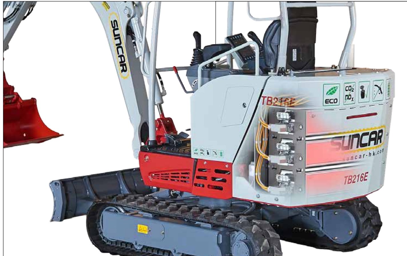
Massives Heck zum Schutz für die wartungsfreie Batterie. Die äusseren Abmessungen weichen nicht von der Originalmaschine ab.
