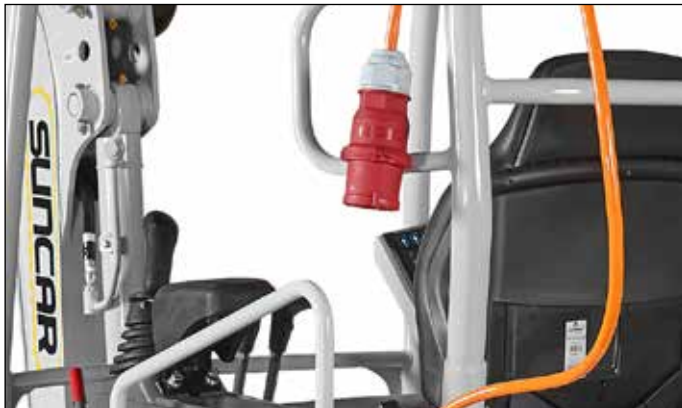
CEE 32A Stecker wird für das Laden, wie auch für den Kabelbetrieb verwendet.
